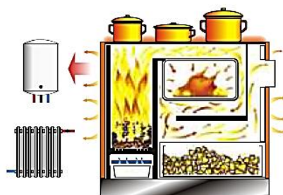
Vintereldning ⇒ Matlagning, bakning, tappvarmvatten, och det centrala värmesystemet
